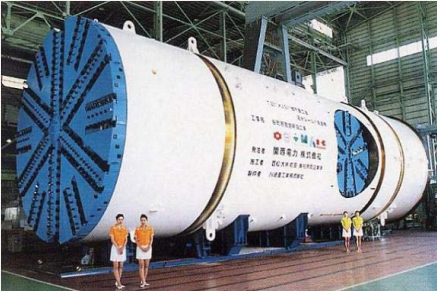
土木 谷町筋管路(分岐シールド) [大阪府]
